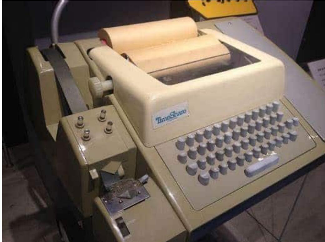
Dans les années 70 sont apparus, des téléimprimeurs ressemblant à des machines à écrire qui avait pour sortie une imprimante.
