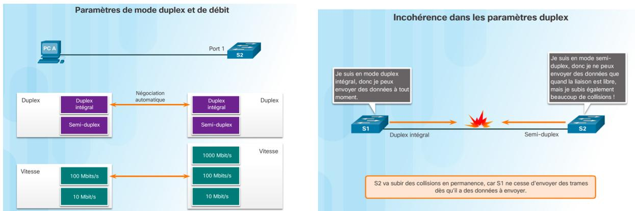
Les paramètres de bande passante et de mode duplex de chaque port de commutateur sont des paramètres fondamentaux. Il est essentiel que ceux du port de commutateur et des périphériques connectés (ordinateur ou autre commutateur) soient en adéquation.
