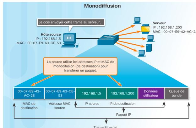
Avec Ethernet, des adresses MAC différentes sont utilisées pour la monodiffusion (unicast), la multidiffusion (multicast) et la diffusion (broadcast) sur la couche 2.
