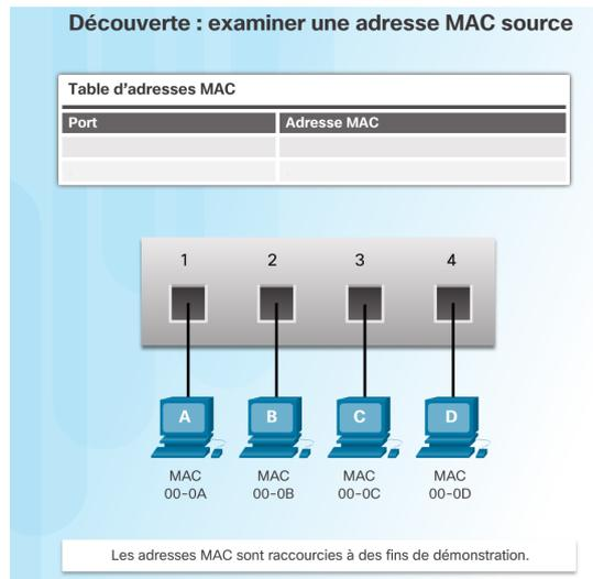
Un commutateur Ethernet de couche 2 utilise des adresses MAC pour prendre des décisions de transmission. Il ignore totalement le protocole transporté dans la partie données de la trame, tel qu'un paquet IPv4. Les décisions du commutateur concernant la transmission de données reposent uniquement sur les adresses MAC Ethernet de couche 2.
