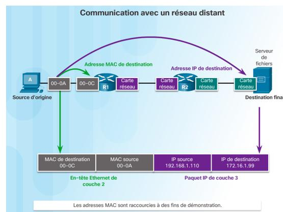
Lorsque l'adresse IP de destination appartient à un réseau distant, l'adresse MAC de destination est celle de la passerelle par défaut de l'hôte, c'est-à-dire la carte réseau du routeur, comme le montre la figure. Si l'on fait l'analogie avec la poste, ce processus reviendrait à déposer une lettre au bureau de poste le plus proche. Il suffit d'apporter la lettre au bureau de poste, qui prend alors la responsabilité de l'acheminer jusqu'à sa destination finale.
