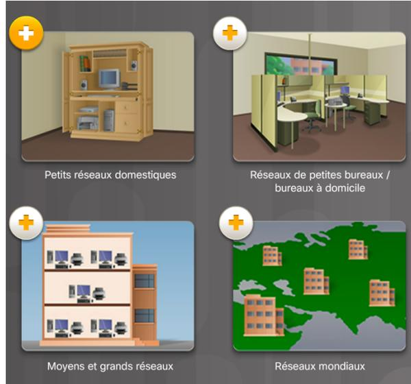
Les réseaux peuvent être de différentes tailles. Leur gamme s'étend des réseaux élémentaires, constitués de deux ordinateurs, aux réseaux les plus complexes, capables de connecter des millions de périphériques.
